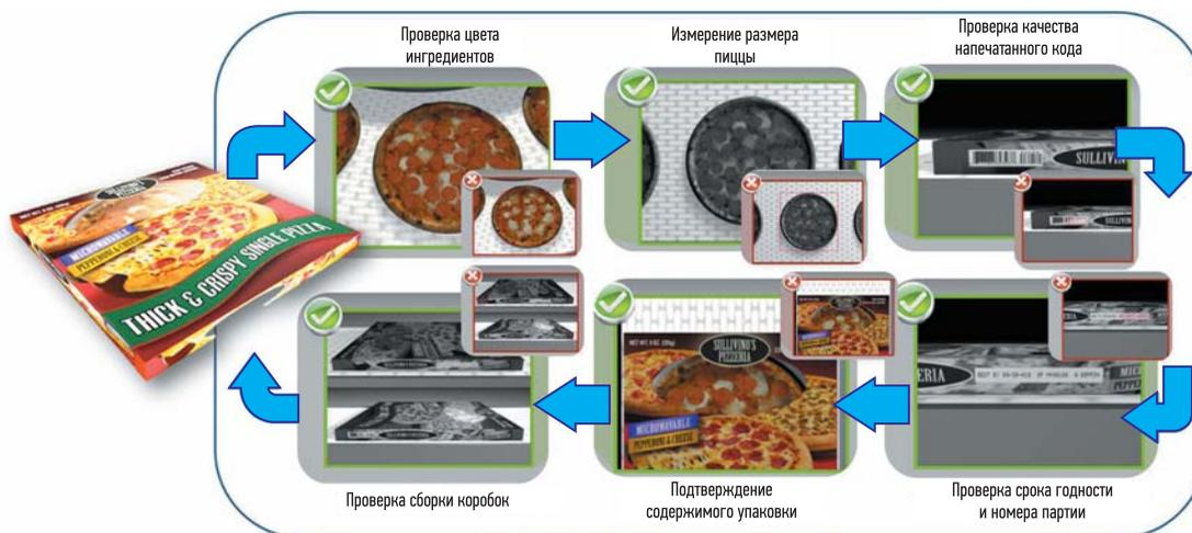
РИС. 1. ◀ Контроль производства и упаковки готовых блюд системой Cognex In-Sight
